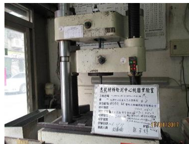
鋼筋拉伸試驗
