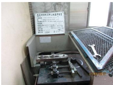
鋼筋抗彎試驗
