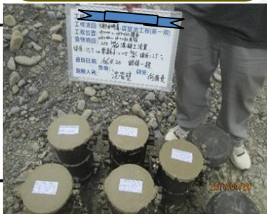
混凝土試體取樣
