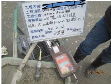
混凝土氣離子試驗
