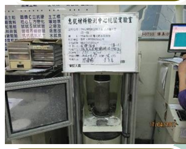
混凝土試體抗壓
