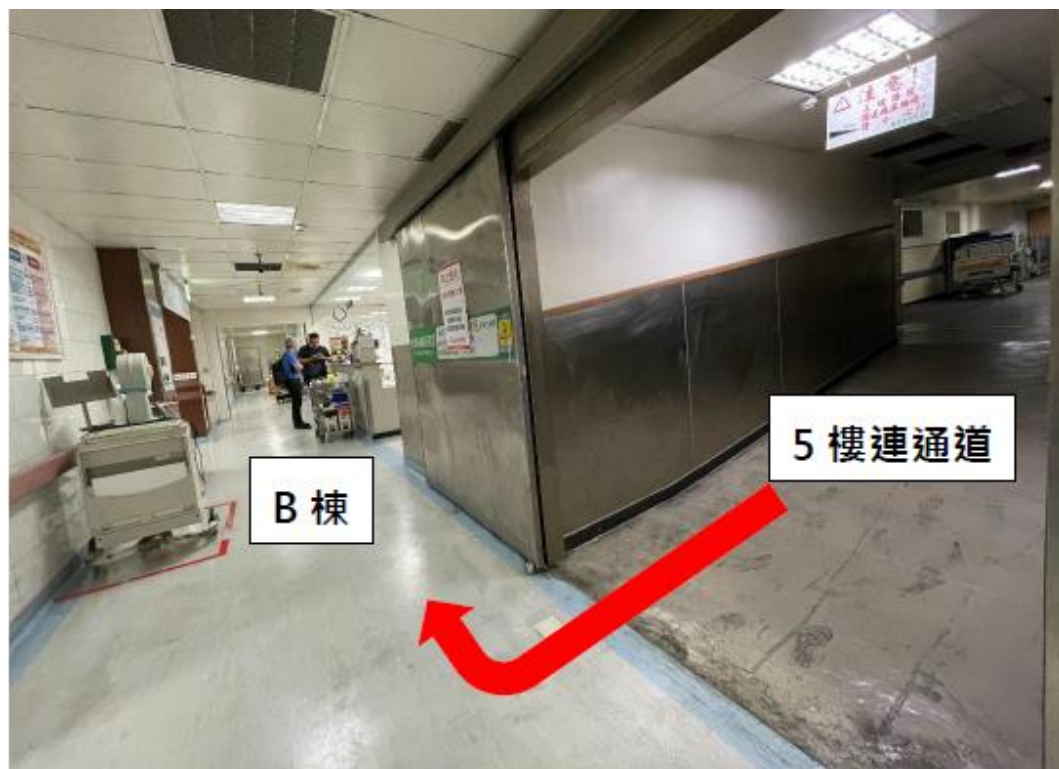
圖 16.5 樓連通道靠近 B 棟端出入口疏散路徑（紅色箭頭所示），需 90 度轉彎方能進入 B 棟大樓區域
