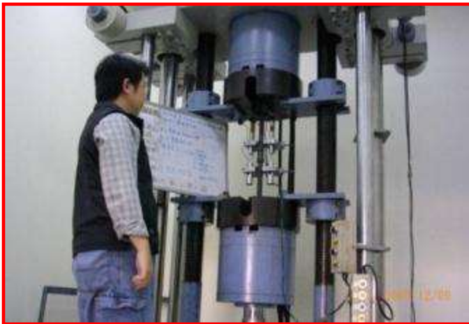
續接器鋼筋試驗
