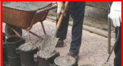
混凝土抗壓強度試驗
