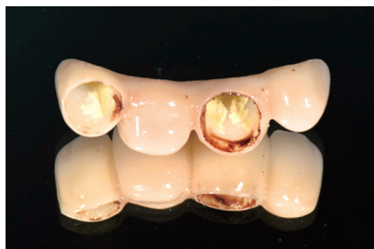
圖 3 黏著固定式義齒鬆脫，可見義齒有因鬆脫、滲漏，而導致黏合劑的變色。
