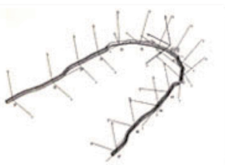
● 圖 4-26：彎線機器人製成的 InCognito 舌側矯正齒弓合金線（Orthodontics. Current Principles and Techniques, 6 th edition.）
