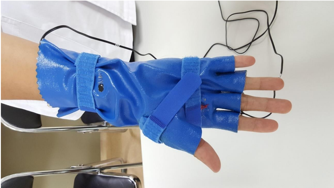
圖九、手套初始型：測試後發現穴位接電刺激時會電流忽強忽弱或沒有、穴位無法精準對準、自行操作不易、貼合度不足、手掌不適感等問題進行修正
