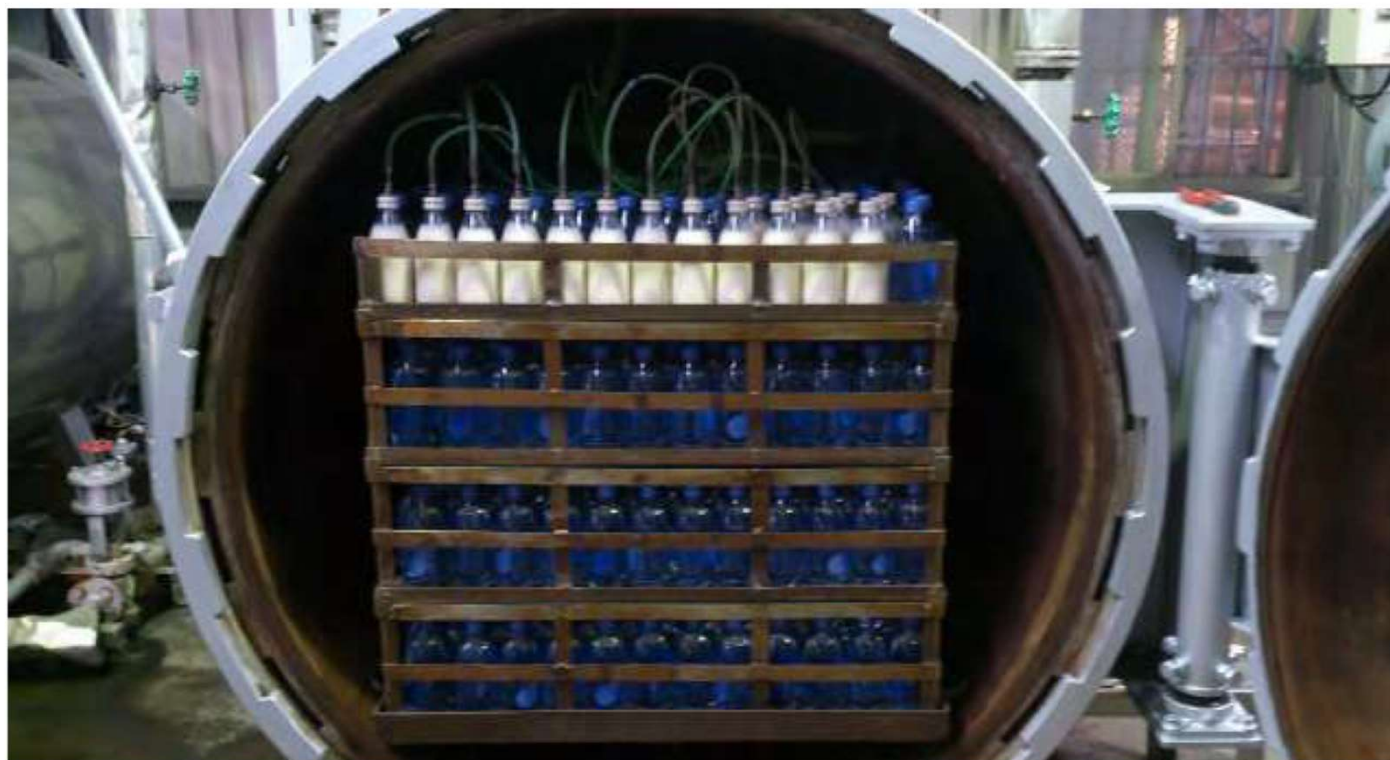
圖 2、熱穿透試驗情形
