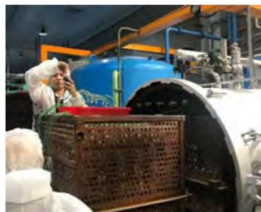
圖 7、殺菌釜熱分佈實際測試設備及情形
