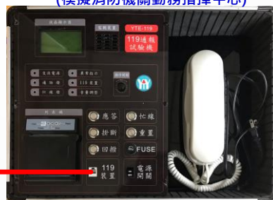
119火災通報裝置試驗機 (模擬消防機關勤務指揮中心)
