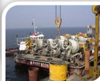
平台船載運 混凝土拌和車
