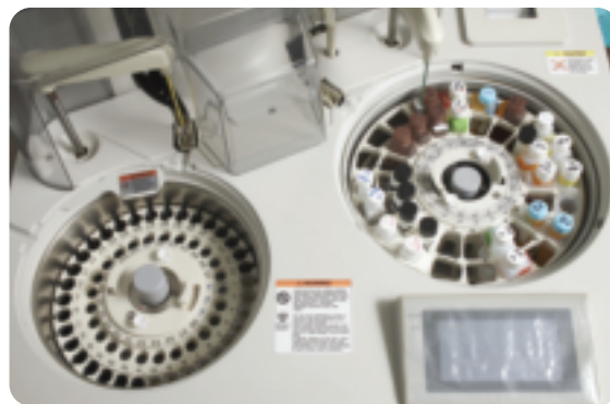
■ 台灣的毒品篩檢技術與世界同步，左圖為確認檢驗儀器「氣相層析質譜儀」，上圖為初步檢驗免疫學分析儀器。
