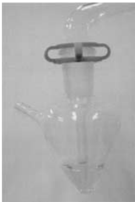
圖十、加入氫氧化鈉溶液至溶液顏色呈橄欖綠色
