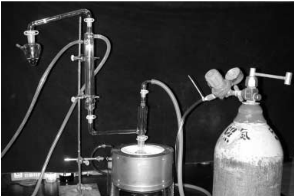
圖八、實驗室通氣蒸餾裝置
