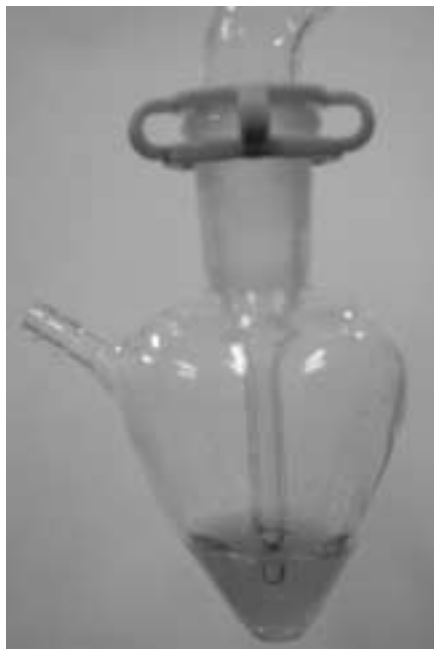
圖九、加混合指示劑三滴後溶液變成紫色
