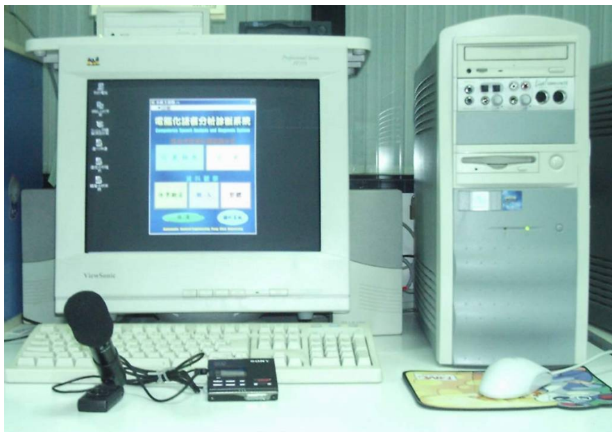
圖 4 語音錄製暨分析設備硬體外觀
