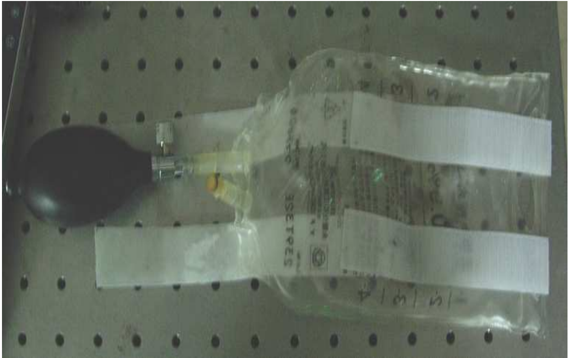
圖3.2 自製仿手指壓力氣球
