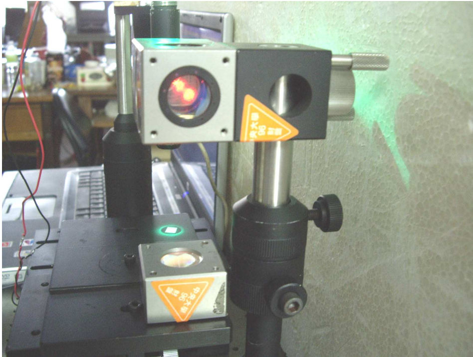
圖 1.23 雷射動態校準儀架設圖
