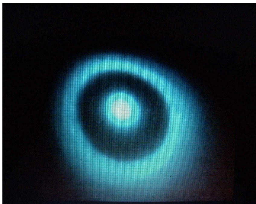
圖 1.17 光源投影到平面聚焦情形
