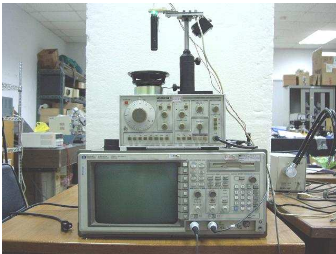
圖 1.26 頻率校正實驗架構圖
