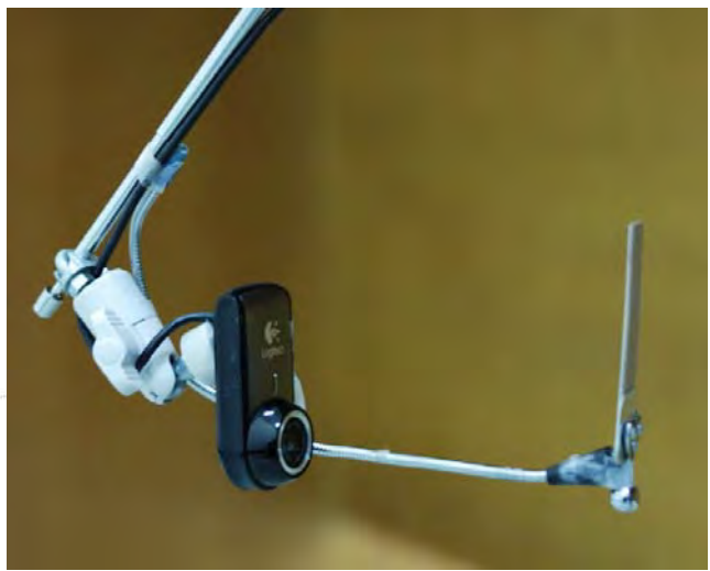
圖 23、「可調式旋轉支架」之縱向旋轉(pitch)、橫向旋轉(roll)與擺動(yaw)
