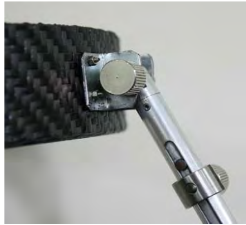
圖 28、「可調式伸縮桿件」之縱向旋轉(pitch)與伸縮平移(translation)
