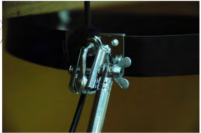
圖 22、「可調式伸縮桿件」之縱向旋轉(pitch)與伸縮平移(translation)
