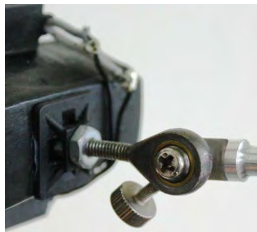
圖 30、標準校色卡調整桿件(鵝頸管 gooseneck)
