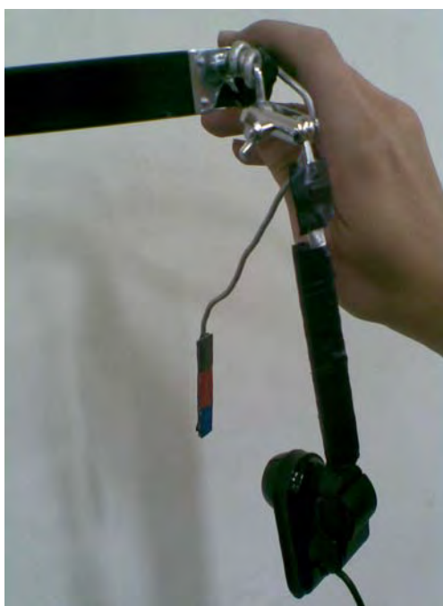
圖 10、定桿機構之可調式伸縮頭套
